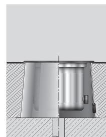
Bei einer Verwendung der Leuchten mit Einbaugehäuse ist bauseits ein Fundament einschließlich Drainage zu erstellen.
